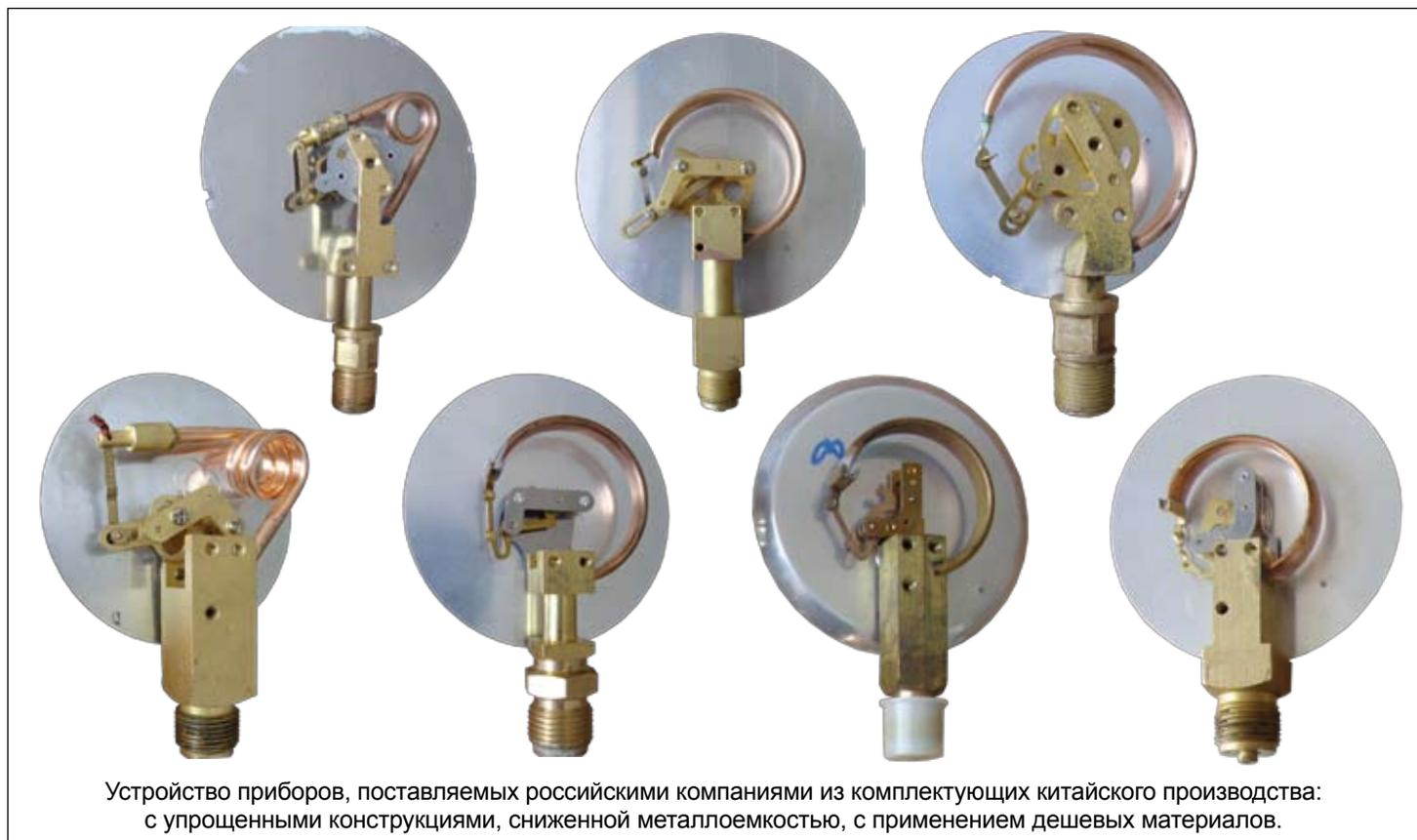
Устройство приборов, поставляемых российскими компаниями из комплектующих китайского производства: с упрощенными конструкциями, сниженной металлоемкостью, с применением дешевых материалов.
