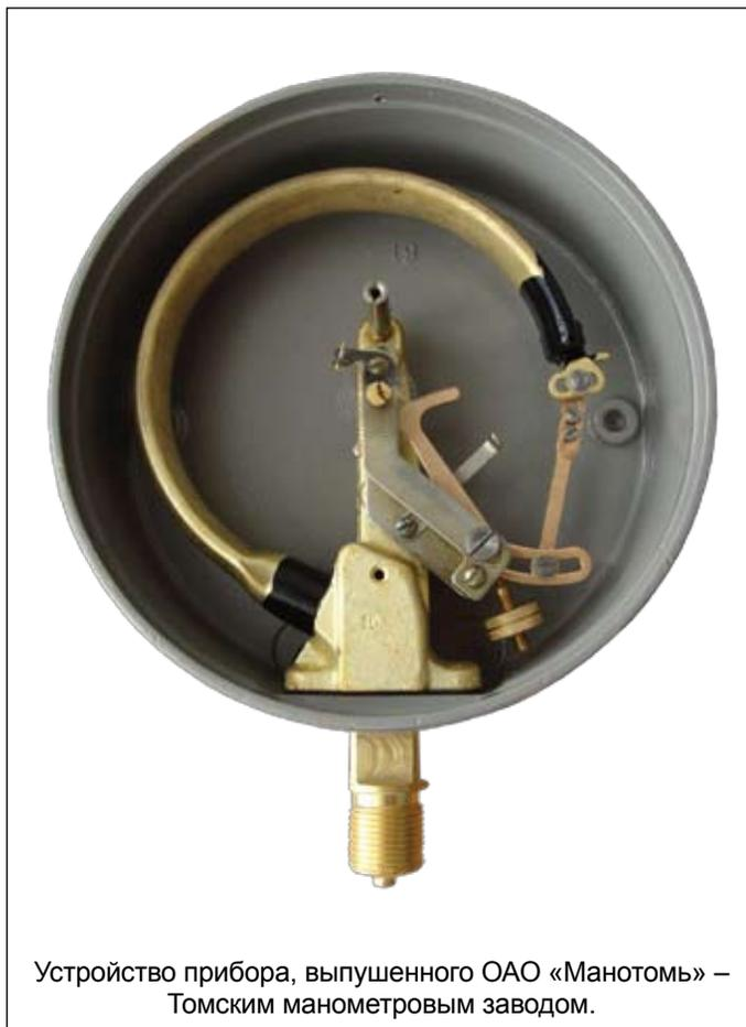
Устройство прибора, выпущенного ОАО «Манотомь» – Томским манометровым заводом.
